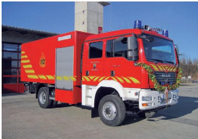
Der GWL 2 dient zum Verlegen von längeren Schlauchstrecken (2.000 Meter – Ersatz für SW 2000, deshalb Funkrufname 88/1) und zum Transport von Einsatzmaterial. Um den GWL möglichst schnell beladen zu können, ist das Material auf Gitterboxpaletten verlastet. Weitere Einsatzmittel für dieses Fahrzeug: 4 Wassersauger, 15 Tauchpumpen, 1 Spechtenhauser Pumpe mit Zubehör, Ölbinder und Fließ, eine 2. TS 8/8 und Material zum Hochwasserschutz.
