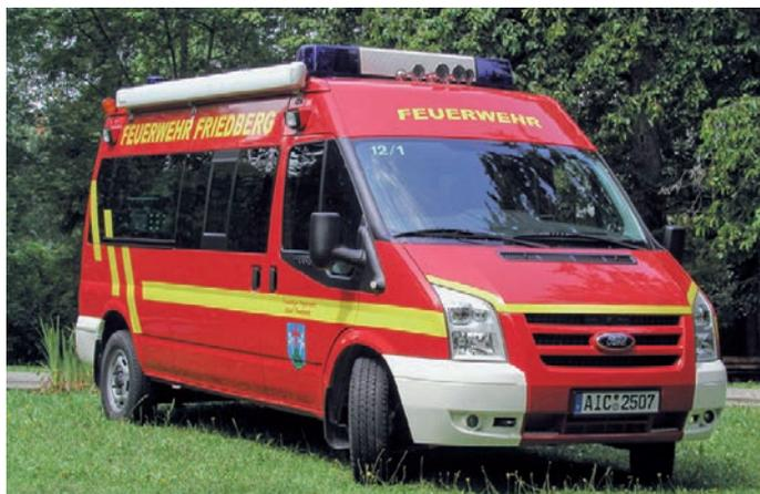
ner internen Einsatzleitung vor Ort und zum Mannschaftstransport. Das Fahrzeug ist folgendermaßen beladen: mehrere tragbare 2-Meter Funkgeräte, 2 x 4-Meter Fahrzeugfunk, tragbarer Computer inkl. Drucker, Scanner und Kopierer, Telefon, Fax, mobile Lautsprecheranlage für Durchsagen und Absperrmaterial.
